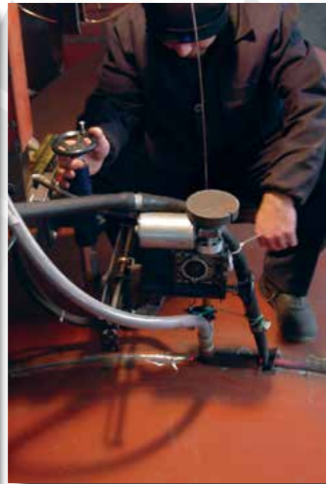
Tozaltı Kaynak Ekipmanı ve Kolon-Bom Sistemi Submerged Arc Welding Machine and Column-Boom System
