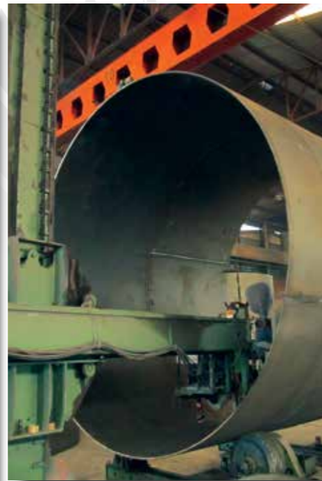
Tozaltı Kaynak Ekipmanı ve Kolon-Bom Sistemi Submerged Arc Welding Machine and Column-Boom System
